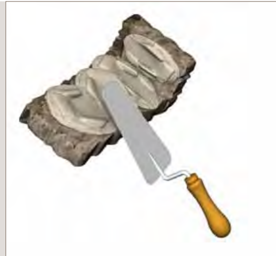
Anwendung auf der Steinrückseite nur mit Kelle
