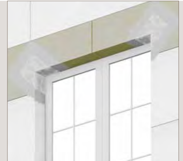
diagonales Armierungsgewebe und Steinwollplatte
