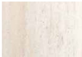
Travertin Classico gegen Lager geschnitten/ tagliato in controfalda Italien/Italia
